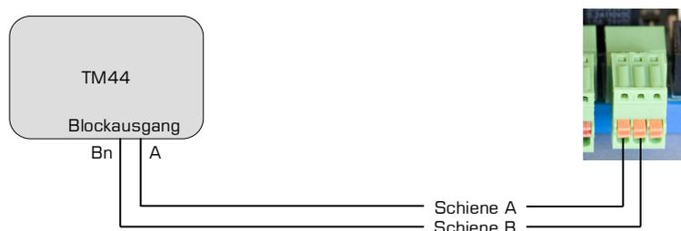
Bei 3-Rail verbinden Sie den Anschluss für die Mittelleiter Ihres Digitalsystems an Pin 3. Der Anschluss für die Schienen Ihres Digitalsystems geht an Pin 1 und der gleiche Anschluss für die Schienen geht über einen Belegungsmelder an Pin 2.
