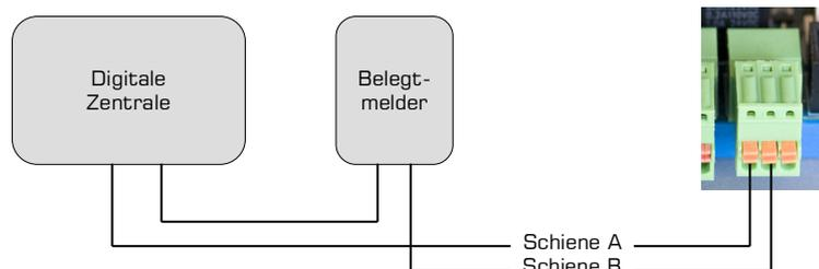
Bei Verwendung eines Dinamo-Systems verwenden Sie einen freien Blockausgang eines TM44 oder TM H+CD16. Die A-Klemme an Pin 1, eine der B-Klemmen an Pin 2.
