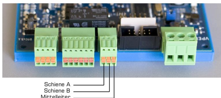
Der DTCv3 kann die Polarität des Gleises auf der Brücke umkehren, um sicherzustellen, dass es mit der Polarität der Ausfahrten identisch ist. Schiene A und B werden zwischen J6 und J7 vertauscht, bei umgekehrter Polarität.
