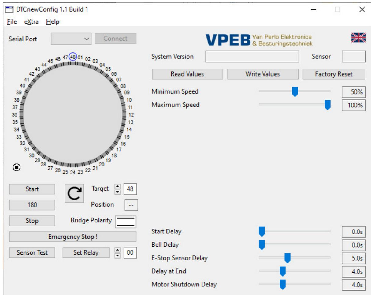
Stellen Sie sicher, dass der DTS-, DTZ oder DTx-Sensor mit dem DTC verbunden ist und schalten Sie die Stromversorgung des DTC ein. **HINWEIS:** Diese Reihenfolge ist wichtig, da der DTC beim Start testet, welchen Sensortyp er hat. Optional können Sie durch Drücken der RESET-Taste einen Neustart erzwingen.
