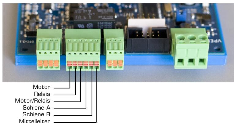
**Achtung DTCv1- und DTCv2-Benutzer: Anschlüsse 2 und 3 sind beim DTCv3 gegenüber dem DTCv1/DTCv2 vertauscht.**
